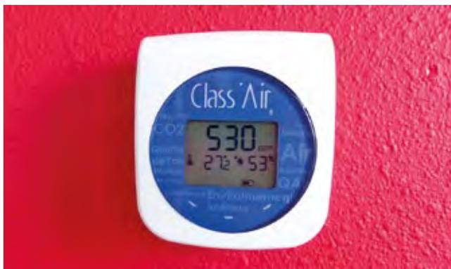
Le capteur Class'Air mesure la teneur en CO<sub>2</sub> des espaces intérieurs
